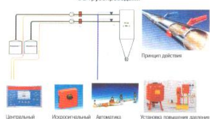
Установка искрогашения для системы удаления пыли с 2 трубопроводами
